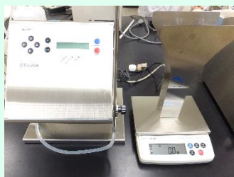
自動秤量分注装置 自動で希釈液を量る
